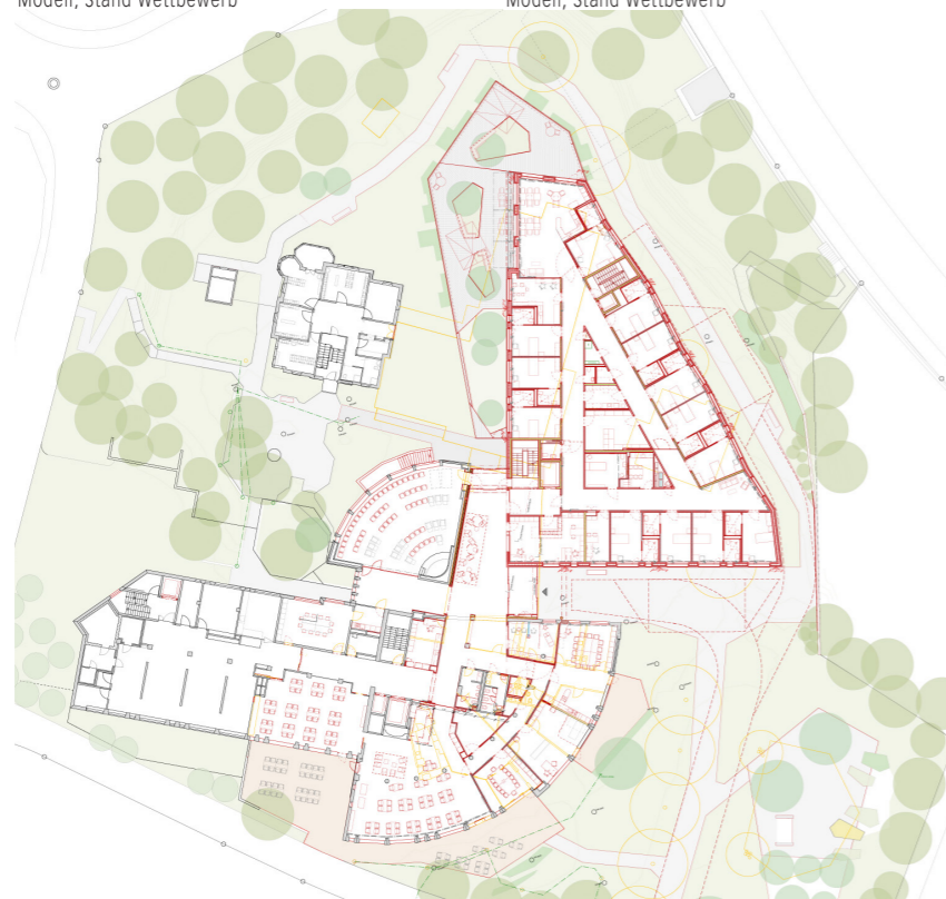
Situation mit Villa, Alt- und Neubau; Erdgeschoss mit Foyer, Cafeteria, Therapieräumen und Dementenabteilung
